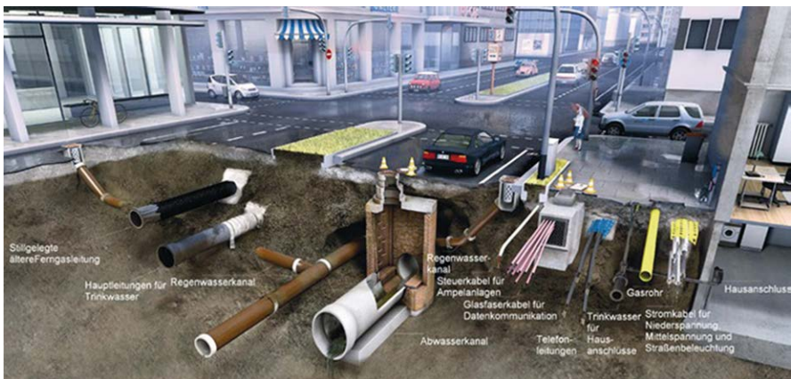
Bild 1 Versorgungsleitungen in der Straße (Quelle: E.ON)
